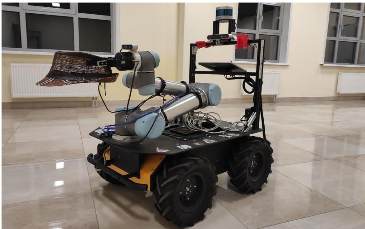
Рисунок 7- Мобильный манипулятор Husky, транспортирующий шляпу
